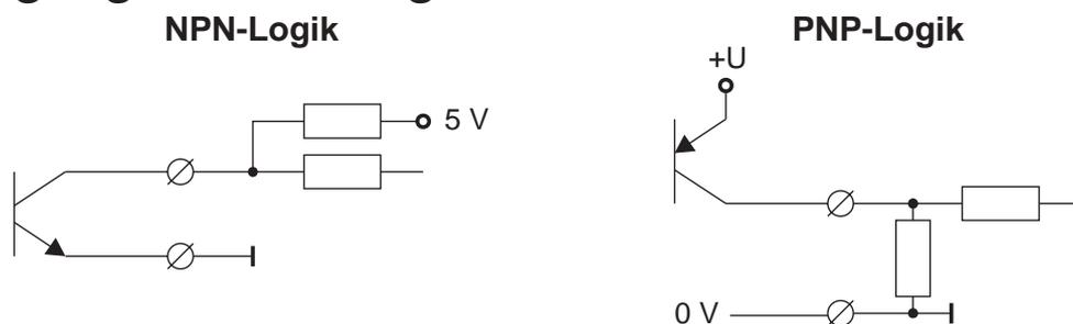
Die Anschlüsse 16 bis 19 sind Signaleingänge für die verschiedenen Betriebsarten. Der Signalpegel (5V bzw. TTL, 12V, 24V) und die Signallogik (PNP, NPN) werden im Parameter 0-01 programmiert.
