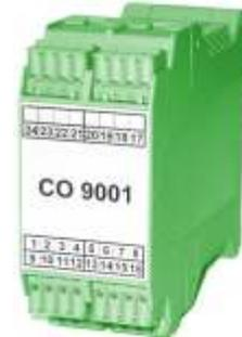
Die Schaltkontakte des Halbleiterrelais können höhere Spannungen schalten. Beim vorliegenden Gerät sind die Schaltkontakte jedoch durch bidirektionale Suppressordioden mit 33 V gegen Überspannungsspitzen geschützt.
