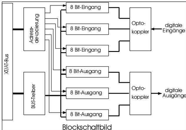
Die Baugruppe benötigt keine Software-Initialisierung. Sie ist nach dem Anlegen der Betriebsspannung und nach erfolgtem Power-on-Reset sofort bereit. Alle Ausgänge werden durch den Power-on-Reset zurückgesetzt.
